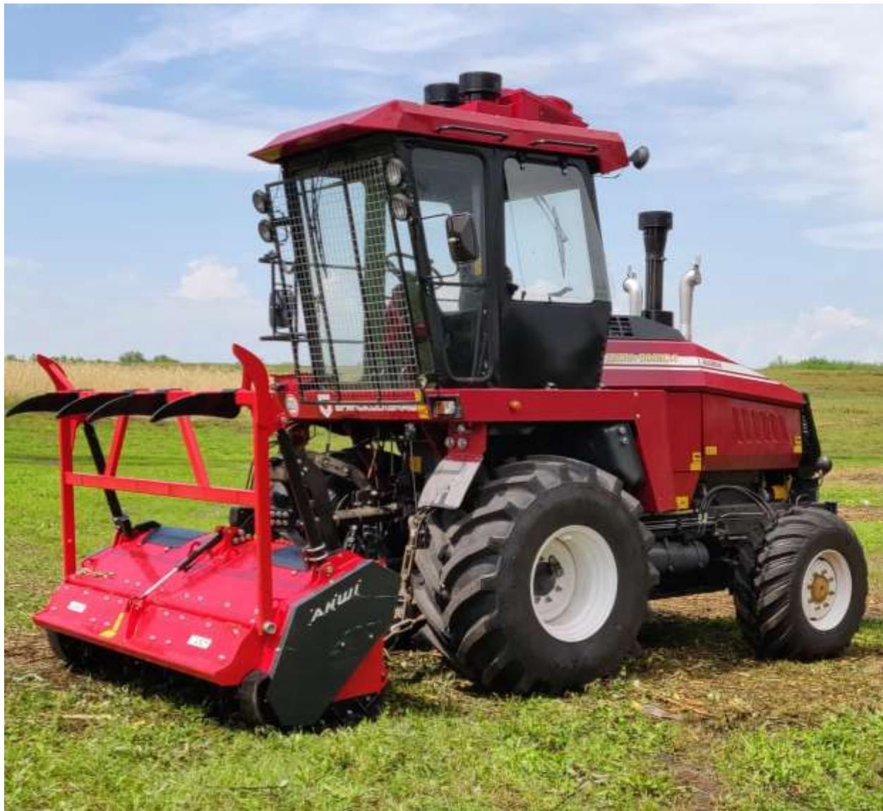
Универсальное энергосредство (УЭС) — самоходная сельскохозяйственная машина, которая отличается способностью передавать до 100% мощности через вал отбора мощности на рабочие (преимущественно вращающиеся) органы агрегатируемых с ним навесных машин. Мощное навесное устройство УЭС дает возможность легко и быстро, не теряя времени на уборке, поднимать и опускать навесные машины при разворотах на краю поля и при переезде на другое поле.
