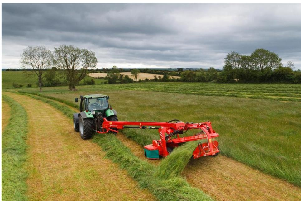
Благодаря таким функциям как полукачающиеся стальные бичи SemiSwing, режущий аппарат, не требующий обслуживания, подвеска SuperFloat, авто-валкоукладчик ВХ и система FlipOver для укладывания скошенной массы в расстил, косилки Kverneland серии 4300 готовы удовлетворить каждый запрос с исключительной производительностью.
