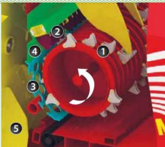
1. **Поперечная балка** – солома вытаскивается из тюка при помощи крючков, расположенных на поперечной балке.
