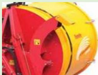
**Выдвижной желоб для соломы** – увеличивает разгрузочную высоту и радиус разбрасывания. Только сухие материалы.
